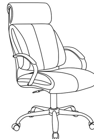
**Примечание:** Шаг 1. Снять защитный колпачок с газлифта, в случае его наличия. Шаг 4-5: Вставить и закрутить винты поочередно, не затягивая их до конца. После выполнения шага 4 закрутить все винты до полной фиксации. Подложить пластиковые шайбы (поз. 15) под передние отверстия опоры.
